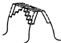
Рисунок 8. Модификация торца зубчатого венца
